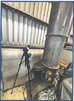
ภาพที่ 5.5-1 ภาพการตรวจวัดคุณภาพอากาศของปล่องระบายอากาศ
